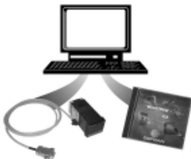
**Nota:** o cabo de interface RS232 para configuração usando o PC é fornecido junto com o software de programação WINSTRUM. A conexão deve ser feita com o instrumento ligado e com as entradas e saídas não conectadas.
